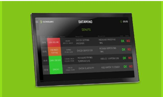
L'operatore può anche interagire con lo strumento e fornire dettagli sulle azioni intraprese a seguito dei messaggi: grazie a questa interazione, è possibile capire se le correzioni apportate hanno portato a successivi miglioramenti. SENSURE SYNAPSE DATAMIND può anche essere integrato con dati provenienti da altri dispositivi sulla linea di produzione.
