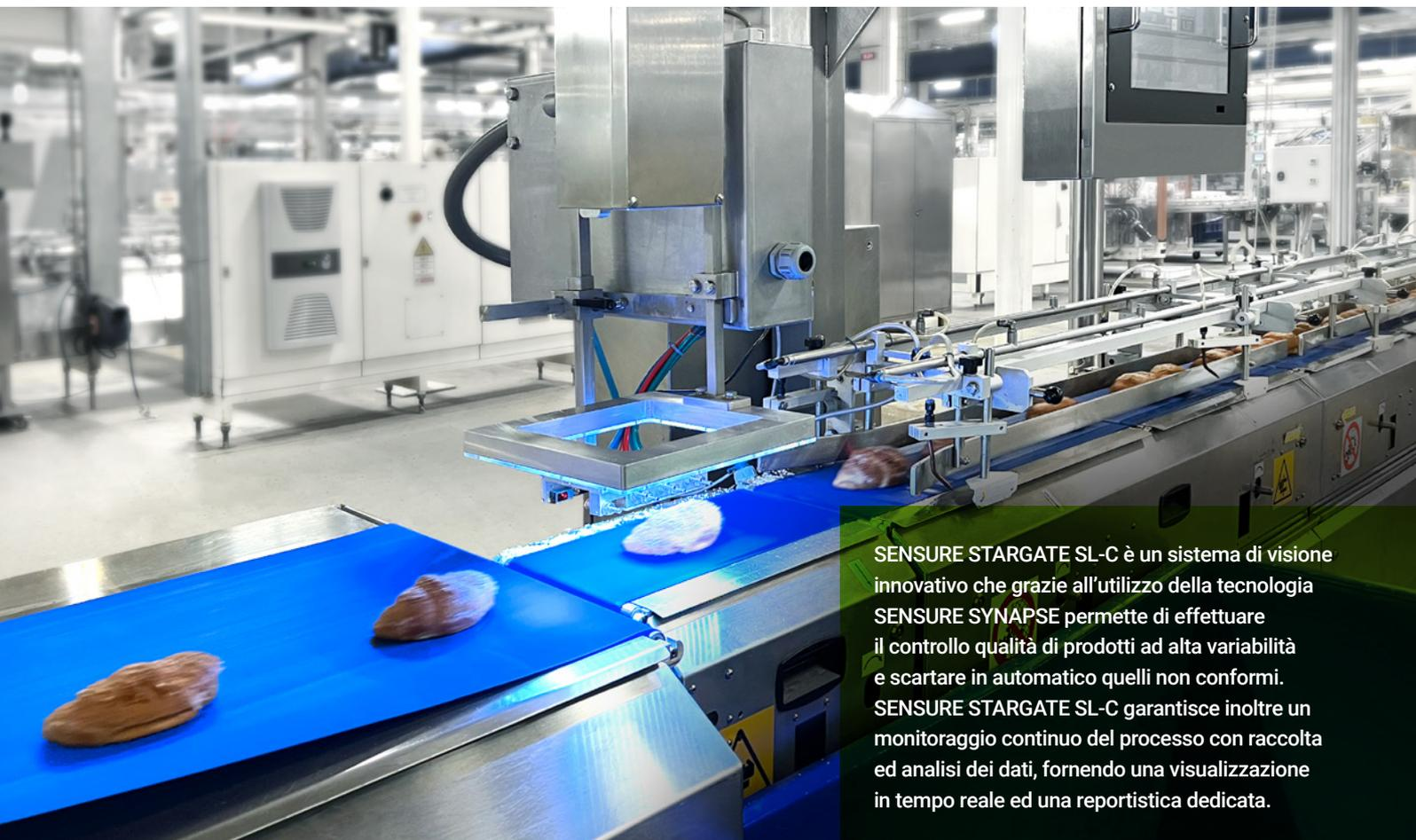
SENSURE STARGATE SL-C è un sistema di visione innovativo che grazie all'utilizzo della tecnologia SENSURE SYNAPSE permette di effettuare il controllo qualità di prodotti ad alta variabilità e scartare in automatico quelli non conformi. SENSURE STARGATE SL-C garantisce inoltre un monitoraggio continuo del processo con raccolta ed analisi dei dati, fornendo una visualizzazione in tempo reale ed una reportistica dedicata.
